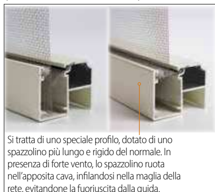
Guida con sistema antivento (brevetto internazionale Bettio)
